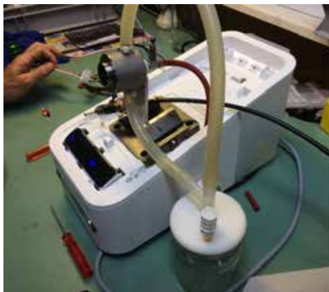
A sinistra: adattamento di un ferro da stiro per lo studio dell'efficienza di pulizia sui connettori di fibra ottica.
