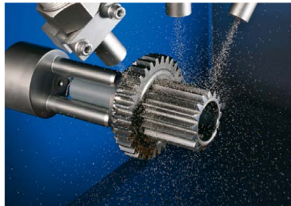
Shot peening di un ingranaggio
